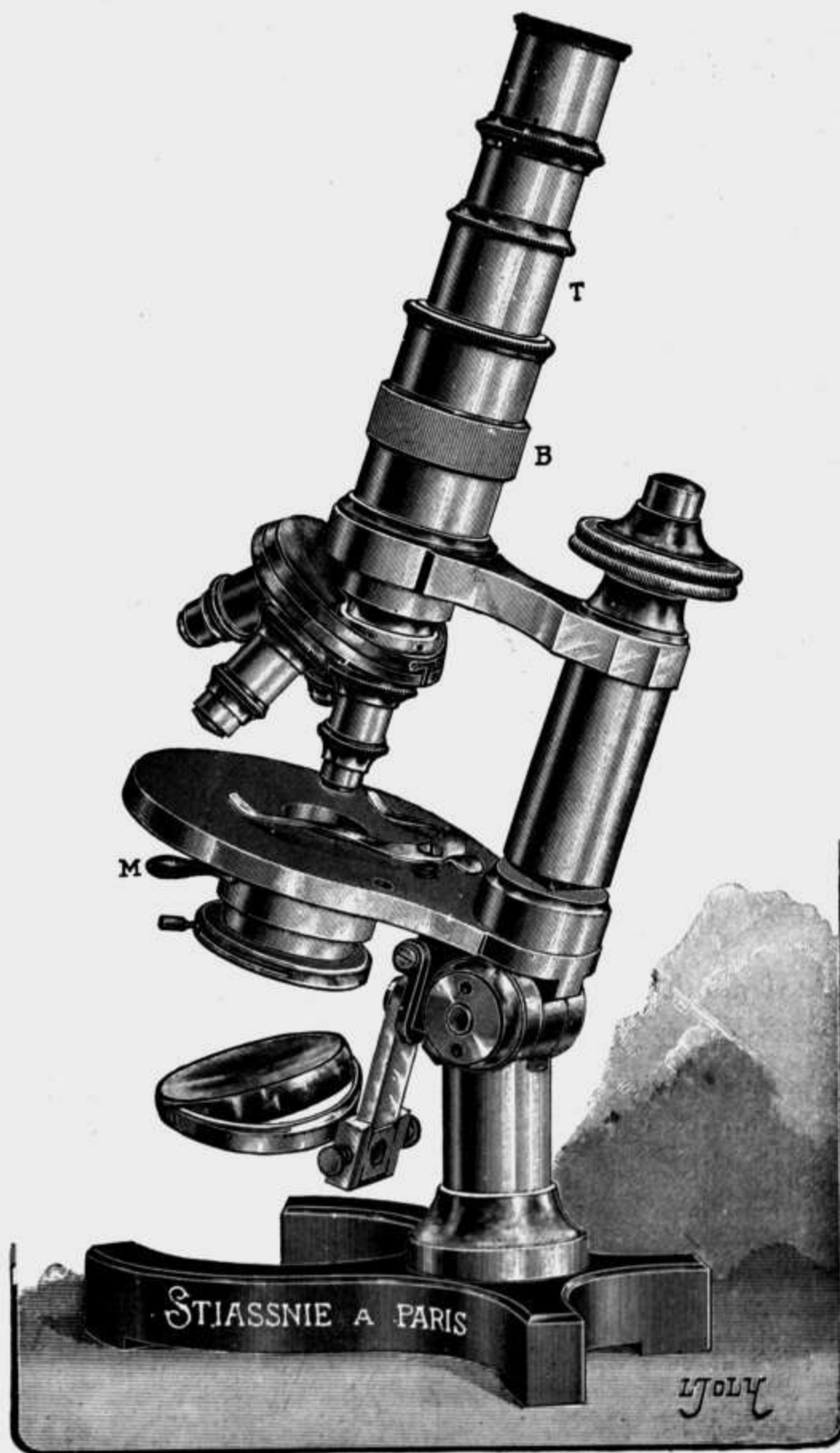
Nouveau microscope à mouvement rapide, sans crémaillère, du professeur Radais.
