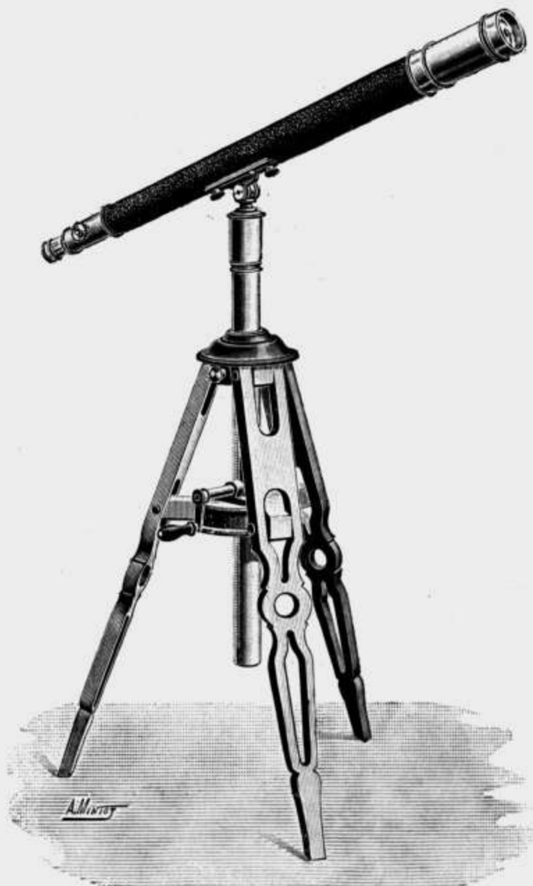
Longue-vue. Grossissement 70 fois. Objectif 75 millimètres. 1/20^{\circ} de la grandeur.
