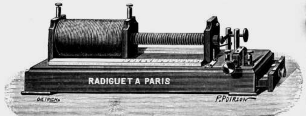
Bobine de Ruhmkoff pour les démonstrations; l'induit et le condensateur se démontent.
