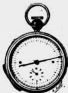
Compteur à secondes enregistreur à l'encre.
