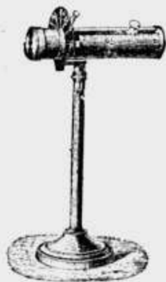
Optomètre du Dr Mergier. au 1/6 e de la grandeur naturelle.
