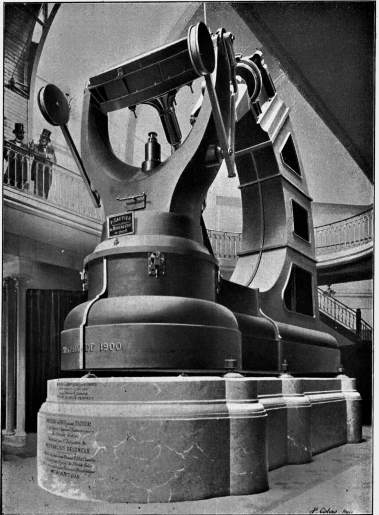
Fig. 4. — Siderostat avec miroir plan de 2 mètres.
