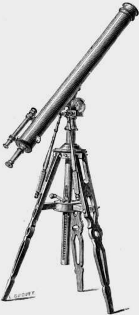
Lunette astronomique et terrestre sur pied de salon avec mouvements lents par vis tangentes.
