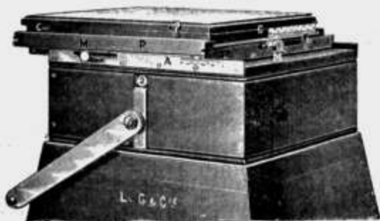
Décentrement de l'amplificateur 24 \times 30 .
